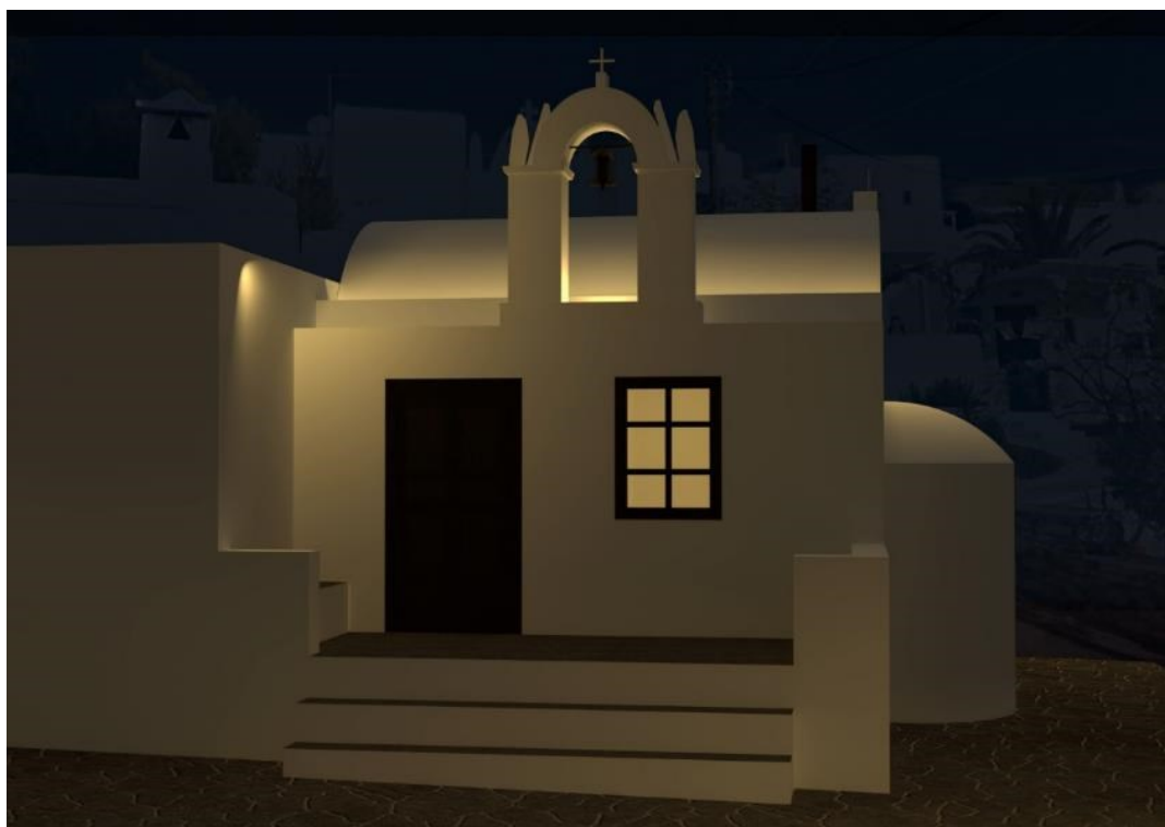
Εικόνα 1. Φωτιστικός προβολέας στο τοιχίο της εκκλησίας και φωτιστική ταινία στη βάση του κωδωνοστασίου-καμπαναριού και στη βάση της καμπύλης της καμάρας της στέγης, φωτιστικός προβολέας στην καμάρα του Ιερού της εκκλησίας.
